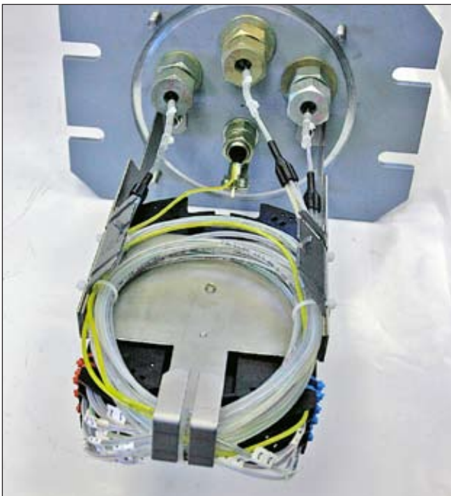
Рисунок 8 - Пример раскладки запаса трубок адаптеров и модулей на кронштейне
