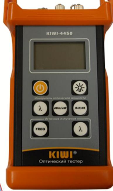
Тестер KIWI-4450 объединяет в себе измеритель оптической мощности, источник излучения и детектор повреждений оптического волокна.
