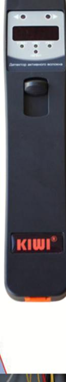
KIWI-4600 - экономичный прибор, позволяющий определить наличие сигнала в волокне без разрывов связи. KIWI-4600 снабжен универсальной тестовой головкой, позволяющей тестировать волокно в буфере 900 мкм, 2 мм и 3 мм. Вносимые потери при этом не превышают 1,5 дБ.
